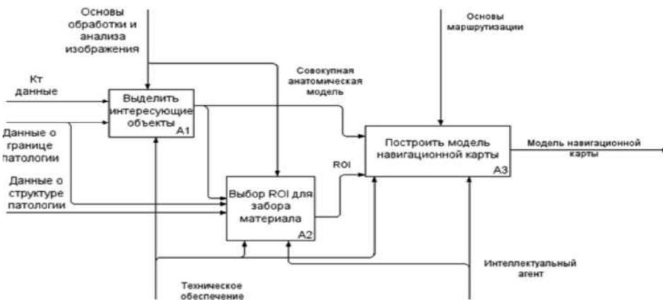
Рис. 2. IDEF0-модель первого уровня «модель навигационной карты для проведения бронхоскопии»
